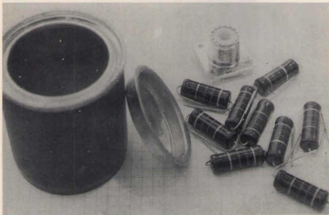
Dummy Load: i principali componenti del carico fittizio: nove resistenze, una presa Amphenol, un barattolo.
